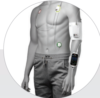
Radius VSM mit SpO2, NIBP, EKG, kontinuierlicher Körpertemperatur, akustischer Atemfrequenz und Überwachung von Orientierung, Position und Aktivität des Patienten
